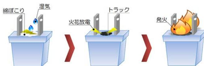
コンセントに差込んだプラグの周辺に綿ぼこりや湿気などが付着することにより差し込みプラグの刃の間に電流が流れ、火花放電を繰り返すことで、絶縁樹脂表面に炭化導電路(トラック)が形成され、発火する現象です。
